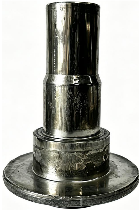
图 2：冷镦成型的毛坯，已基本成型 只需少量机加工即可，无切屑，无材料浪费
