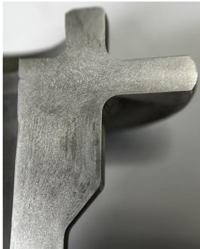
图 3：晶粒流线未被破坏，结构强度更高
